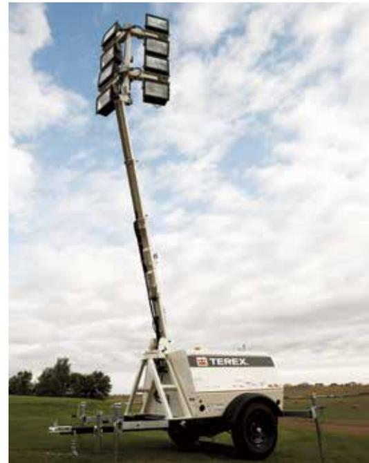
**卓越品质：在所有的特雷克斯品牌灯塔的桅杆系统上都配制了超高分子聚乙烯侧垫，来延长桅杆的使用寿命，减少摩擦并提高耐腐蚀性以消除金属桅杆之间的磨损。**
