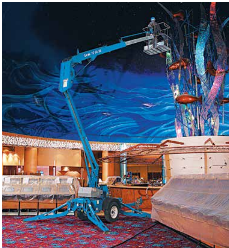
直流 / 汽油混合动力发动机 允许机器在外部场所充电。
