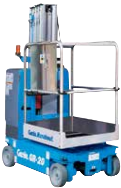
货物采集平台 89 × 73 厘米提供双侧进入门和前折叠托盘。
