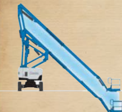
曲臂型高空作业平台的双平行四边形结构
