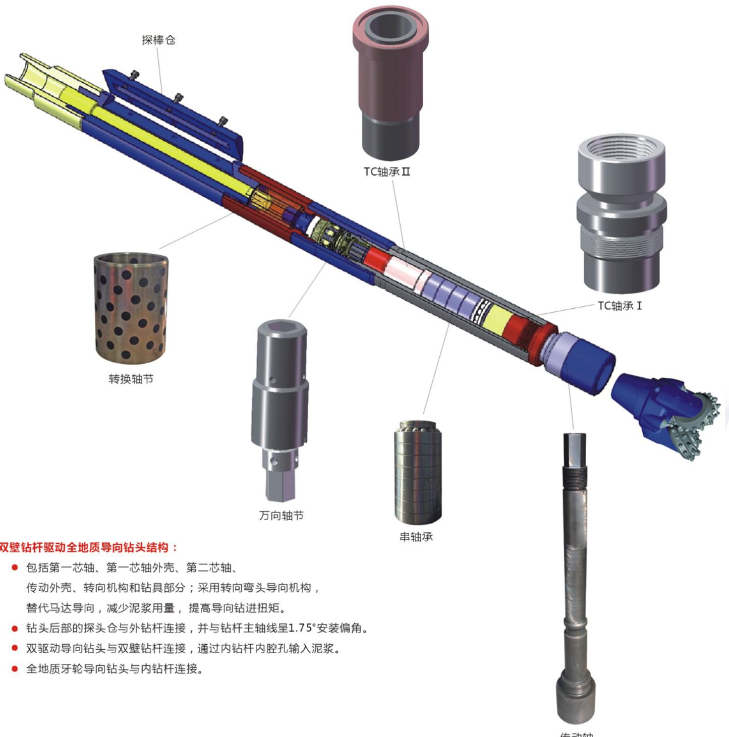
双壁钻杆驱动全地质导向钻头结构：
