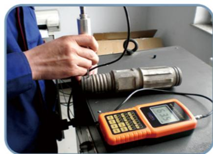
超声波硬度计检验
