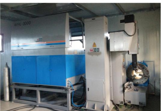
**接头螺纹激光处理**
