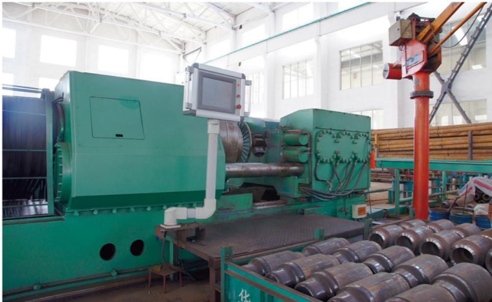
**600T混合式摩擦对焊机**
