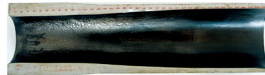
反挤压管端加厚成型
