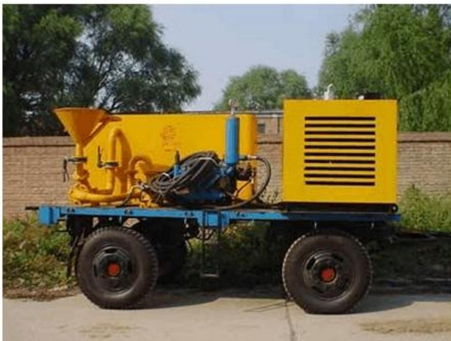
附图：DDW-350 型钻机泥浆制备系统
