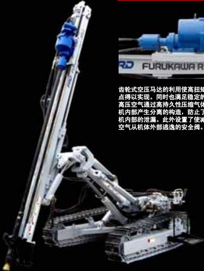
以分体式顶锤钻机中的畅销机型「PCR200」为基础，搭载强力消音型空压旋转凿岩机的分体式潜孔钻机。搭载高性能的潜孔锤、可实现最大直径150mm的钻孔。运用顶锤系统的技术和经验，以及古河自主研发的旋转凿岩机和车体构造、能保持长期稳定的性能。
