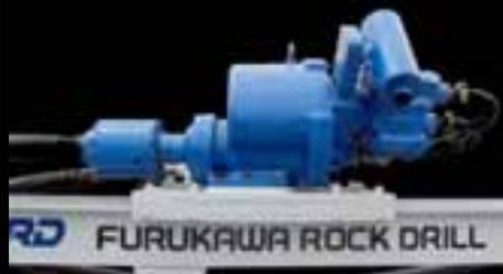
齿轮式空压马达的利用使高扭矩·平坦扭矩的特点得以实现。同时也满足稳定的大口径钻孔性能。高压空气通过高持久性压缩气体用密封圈与减速机内部产生分离的构造，防止了压缩空气往减速机内部的泄漏。此外设置了使减速机内部的膨胀空气从机体外部逃逸的安全阀。
